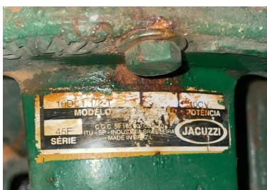
Foto 2: etiqueta original, marca Jacuzzi 10DLT12T série 45F
